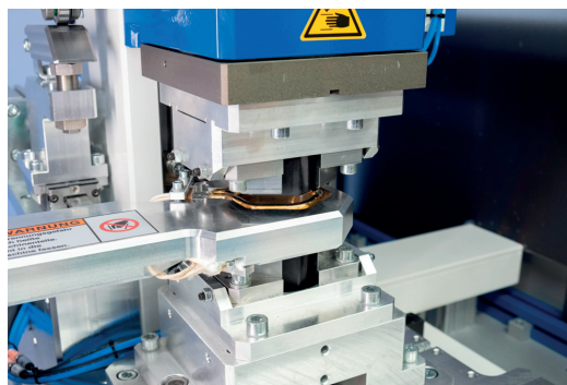
IR-6-Eck-Strahler für Kunststoff-Fügesystem Fa. Fischer-ST und Uni Kassel
