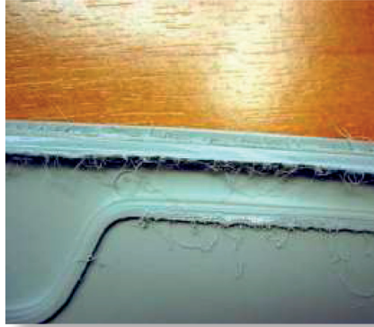
Material PP, Bruchprobe der VIB reibgeschweißten Sonnenblende
