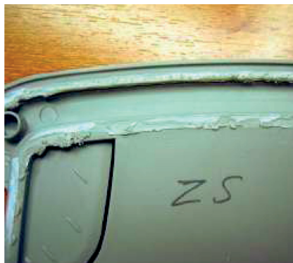
Material PP, Bruchprobe, Innenseite
