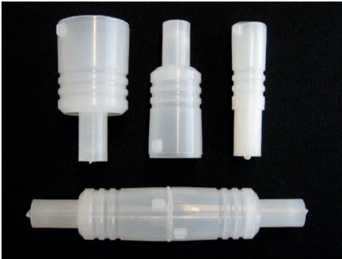
Bild 4: entwickelte Proben für die Durchführung von Schweißversuchen
