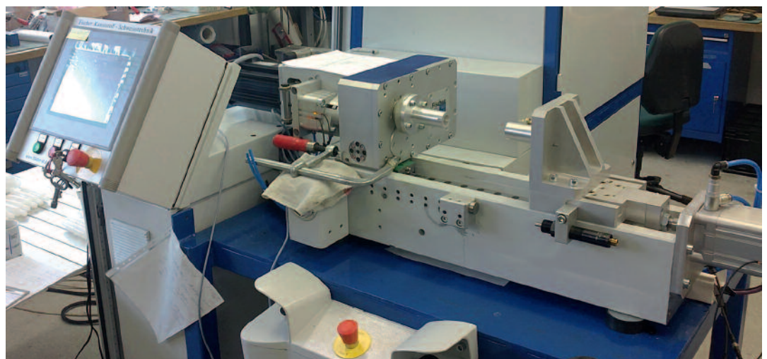
Bild 3: vollwertige Prototypenmaschine mit Zirkularschaltung und Federstangengetriebe
