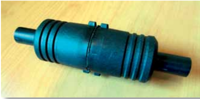
Bild 3: Probekörper aus PA66 Gf30 ausgelegt und hergestellt an der Uni Kassel
