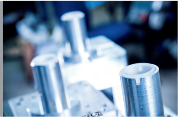
Bild 4: Fügen eines PP-Probekörpers mittel Zirkularschweißen
