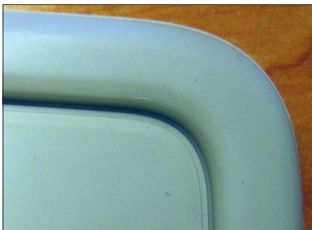
Saubere Abschlusskontur mit Zirkularschweissen (ZS) mit 160 Hz reibgeschweisst.
