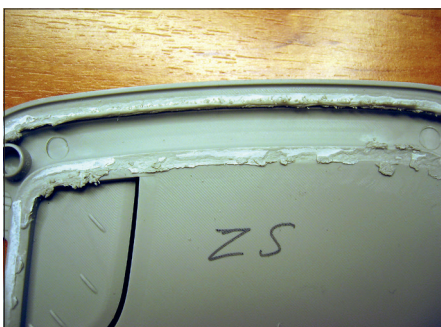
Zusammenhängende Schmelze nach ZS, Material PP, Bruchprobe, Innenseite.
