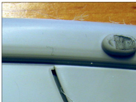
Linear VIB, mit 160Hz: Die Fusselbildung ist bis aussen sichtbar. Hier eine reibgeschweisste Sonnenblende.
