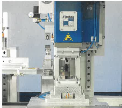
Infrarot-Reibfügemaschine zum partikelarmen Schweißen.
