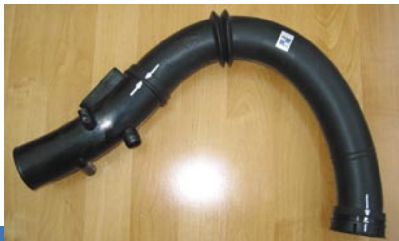
Bild 3: Blasformteil Rohrkrümmer mit Spritzteilen Verteiler und Stützen Zirkularreibschweißen in Doppelstation (Geiger Technik Thüringen)
