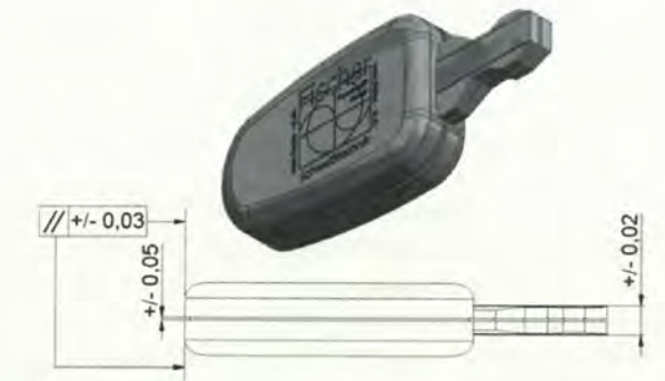
Bild 4: Mit \pm 0,03 mm Toleranz gefügte Halbschalen, \pm 0,05 mm Dekor-Nut und \pm 0,02 mm Fügemaßhöhe
