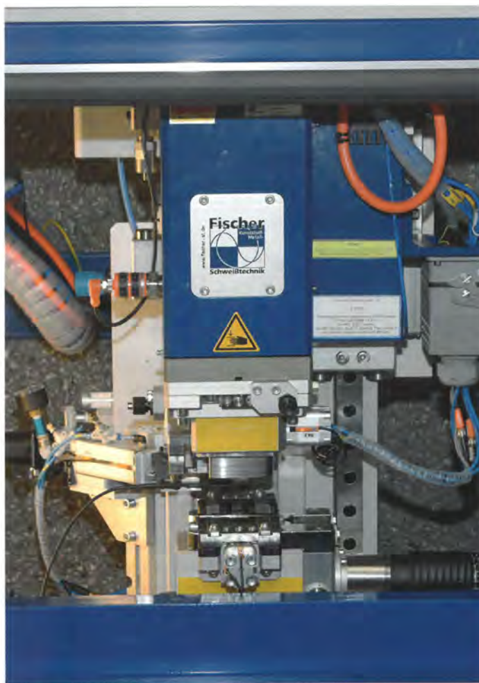
Bild 3: Die Zirkular-Reibschweißmaschine „ZMT 2 CC“ der Fischer Kunststoff-Schweißtechnik GmbH
