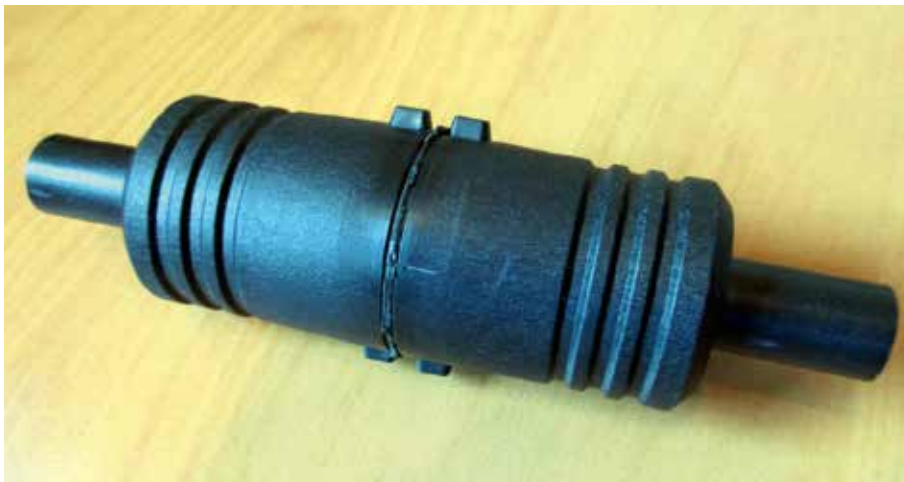
Probekörper: Als Versuchsobjekt diente ein Probekörper aus PA66-GF30 mit 40 mm Durchmesser und 452 mm 2 Fügefläche (© Fischer + Uni KS)
